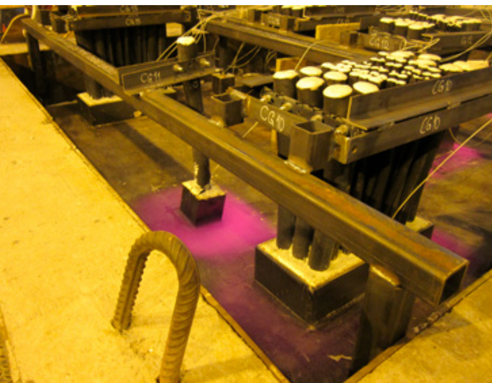
Foto: Firesafe AS Hydrokarbonbrann i skipsdekk.
